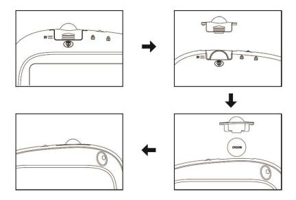
**Sustitución de la pila:** Retire el tornillo de seguridad y extraiga el portapilas, retire la pila, coloque una pila de botón CR 2016 [3V] nueva e introduzca el portapilas nuevamente en la ranura.
